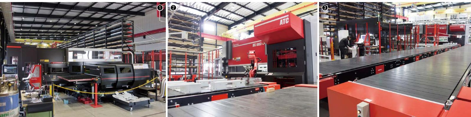
①ファイバーレーザー複合マシンACIES-2512T-AJが、12段11列の自動倉庫MARS-2512N(奥)と連動する／②ベンディングロボットシステムHG-1003ARsが機構部品など小物製品の曲げ加工を行う／③HG-ARsには夜間無人運転に対応して、加工が完了した製品を集積する長さ12mのコンベヤーが2本設置されている
