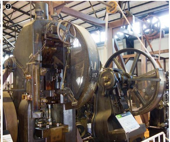
①東京・三田にあった町工場を復元。1台の電動機(5馬力)から平ベルトで上部のシャフトに回転が伝えられ、そこから旋盤・ボール盤・形削り盤・小型横フライス盤などが駆動する／②1台の電動機から平ベルトを通して3台のプレス機が駆動する
