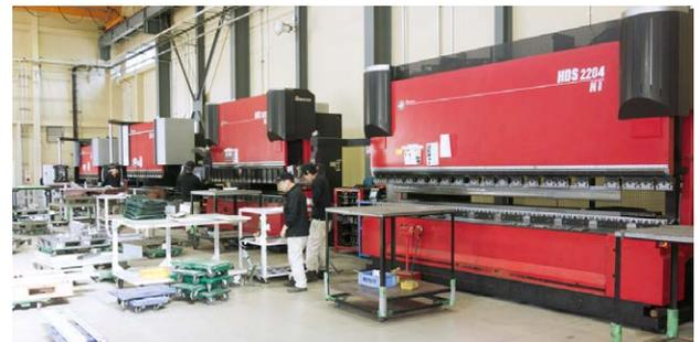
HDS-2204 NT (手前)、HG-1303 (奥から2台目) など長尺製品にも対応できる曲げ工程
