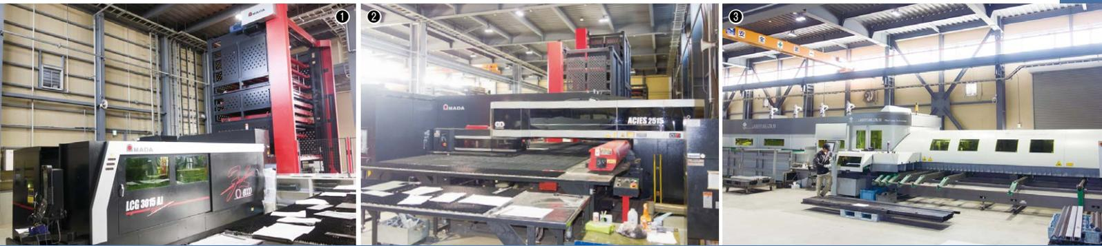
ブランク工程では①2017年に導入したファイバーレーザーマシンLCG-3015AJ+ASFH-3015G、②2015年に導入したパンチ・レーザー複合マシンACIES-2515T+AS-3015NTK+ULS-3015NTKを活用している。③2018年には欧州製のパイプ加工用のファイバーレーザーマシンを導入した
