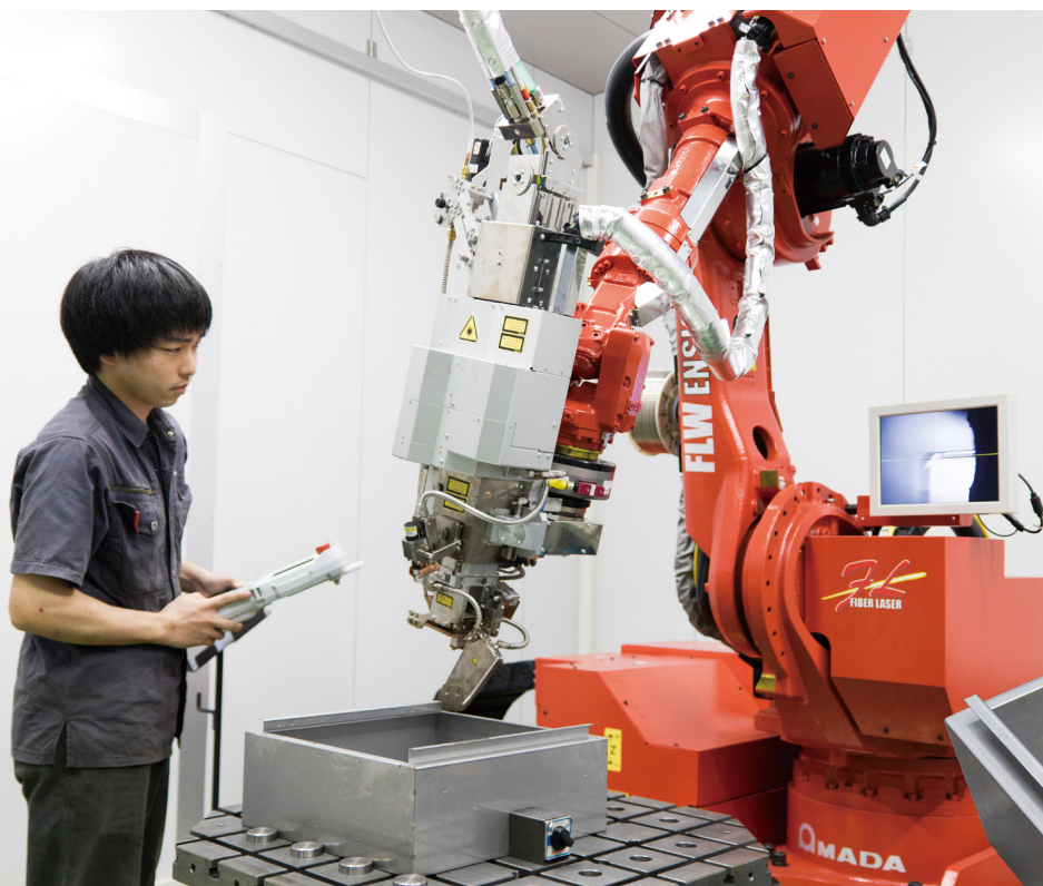
① 2019年6月に導入した2台目のファイバーレーザー溶接システムFLW-3000ENSISのティーチング作業 ② FLW-ENSISで加工した通信機器の筐体
