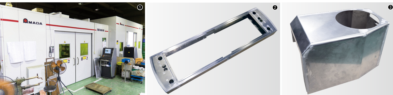
①ファイバーレーザー溶接機FLW-4000M3(手前)とFLW-3000ENSIS(奥)が並ぶ／②オールアルミの筐体(板厚2.0mm・長さ1,200mm程度)。左右・中央で3分割してFLWで溶接している／③アルミ・板厚1.5mm(幅500mm程度)の筐体
