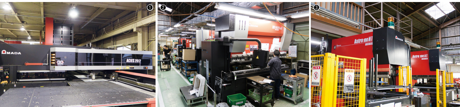
① 2016年に導入した同社初のパンチ・レーザ複合マシンACIES-2512T(2連棚仕様) / ② 曲げ工程。HD-8025NT(手前)、EG-6013(手前から2台目)などが並ぶ / ③ ペンディングロボットシステムASTRO-100NT×2セット。ロット30個以上の製品はできるだけASTROで加工する
