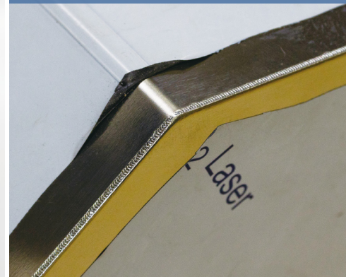
① FLW-4000M3により溶接した筐体 (SUS304) の溶接跡
