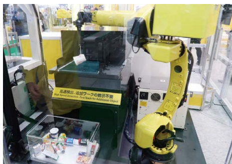
ファナックは新製品として、3次元ビジョンセンサーを搭載したばら積み取り出しロボットを出展
