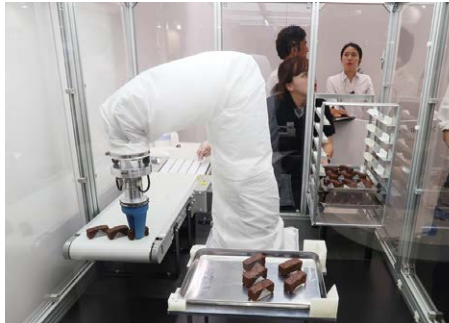
デンソーウェーブは、食品用ロボットジャケットや柔軟物を把持できるロボットハンドを駆使し、ケーキの整列を実演した
