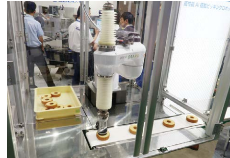
大森機械工業も、デンソーウェーブのロボットとAIビジョンによるバウムクーヘンのピッキングの実演を行った
