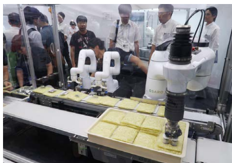
デンソーウェーブは、ロボットピッキング専用AIビジョン、4軸多関節ロボット、人協働ロボットによるラインを出展
