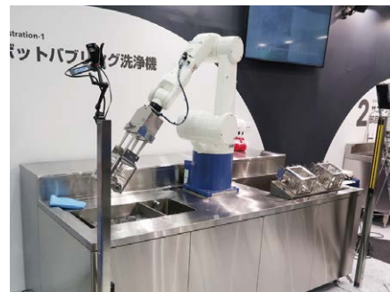
タニコーは、調理器具や産業用部品のロボットバブリング洗浄機を出展。ファインバブルにより洗浄効率も高い
