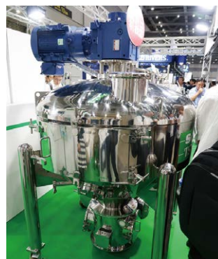
ソディックは、ツカサ工業と共同開発した業界初の粉粒体急速冷却装置を出展した
