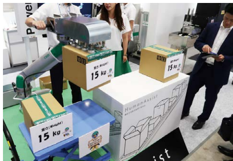
CKDは、重量物の上げ下ろしをサポートする助力装置「パワフルアーム」を出展した
