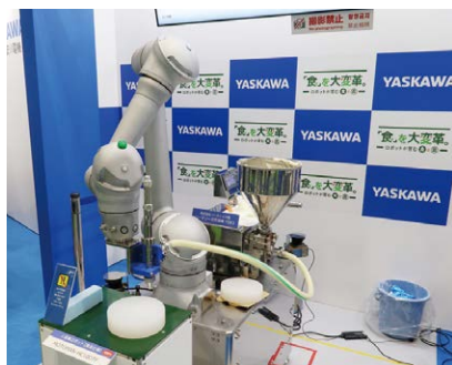
安川電機は、移動が容易でフレキシブルにレイアウトを変更できる人協働ロボット（食品仕様）を出展
