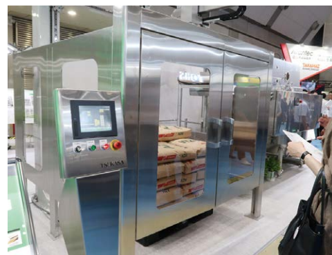
ツカサ工業は、粉袋の供給・異物除去・開袋の機能を備えた粉体自動開袋システムを出展した
