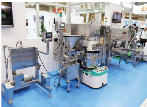
関東混合機工業は、ボールの自動搬送AGVシステムを用いたミキシングの自動化システムを出展した
