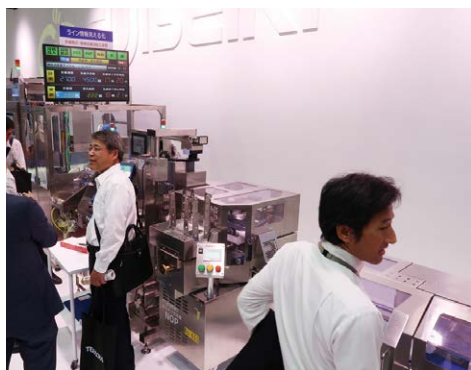
不二精機は、整列ロボットを採用したおにぎりの自動生産ラインを出展。生産状況をモニターで確認できる
