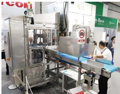
前川製作所は、チキン骨付きもも肉全自動脱骨ロボット「トリダス」の自動投入ロボットシステムを出展
