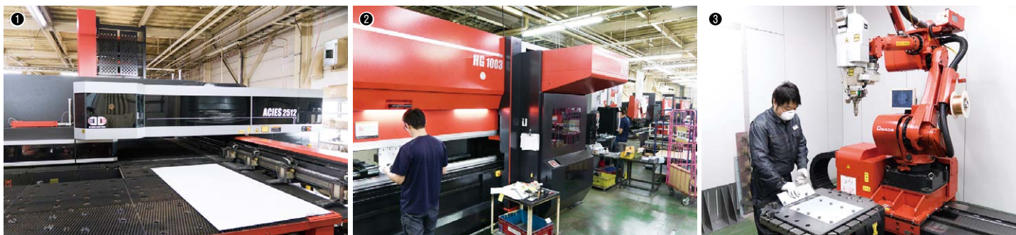
①ブランク工程にはパンチ・レーザ複合マシンACIES-2512T(写真)をはじめ3台の複合マシンを設備している／②曲げ工程。自動金型交換装置付きベンディングマシンHG-1003ATC(手前)などを活用している／③ファイバーレーザ溶接システムFLW-4000M3。オペレータは入社1カ月目の社員
