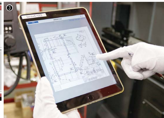
① 2018年末に導入したV-factory Connecting Box。表示されているのは工程管理板Kaizenの画面／ ②板金製造支援システムvLot Managerの画面／③現場のタブレット端末から図面データも閲覧できる
