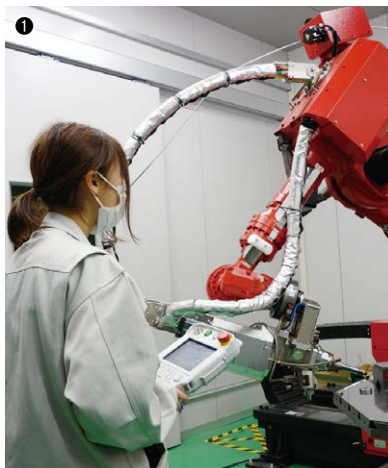
① 2017年に導入したファイバーレーザ溶接システムFLW-3000ENSISのティーチング作業を行う女性社員／ ② FLW-3000 ENSISによる溶接作業を行うためのティーチング作業／③ 2012年に導入したファイバーレーザ溶接システムFLW-4000のTAS(ティーチング・アシスト・システム)で溶接線を補正する女性社員
