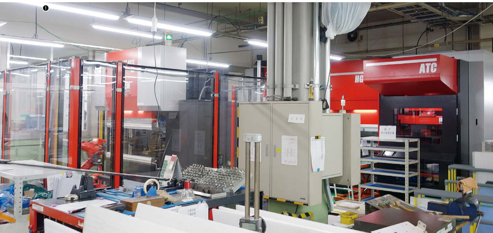
①自動金型交換装置を備えたベンディングマシンHG-1003ATC(右)とベンディングロボットシステムEG-6013AR(左)／②EG-6013ARで曲げ加工した製品
