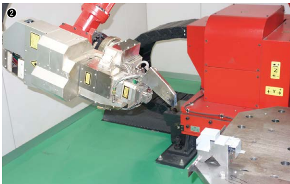
① 2017年に導入したファイバーレーザ溶接システムFLW-3000ENSISのティーチング作業を行う女性社員／ ② FLW-3000 ENSISによる溶接作業を行うためのティーチング作業／③ 2012年に導入したファイバーレーザ溶接システムFLW-4000のTAS(ティーチング・アシスト・システム)で溶接線を補正する女性社員
