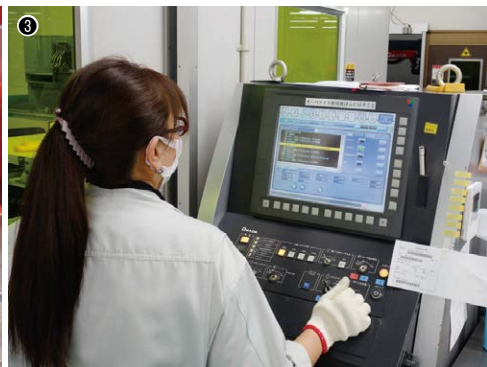
① 2017年に導入したファイバーレーザ溶接システムFLW-3000ENSISのティーチング作業を行う女性社員／ ② FLW-3000 ENSISによる溶接作業を行うためのティーチング作業／③ 2012年に導入したファイバーレーザ溶接システムFLW-4000のTAS(ティーチング・アシスト・システム)で溶接線を補正する女性社員
