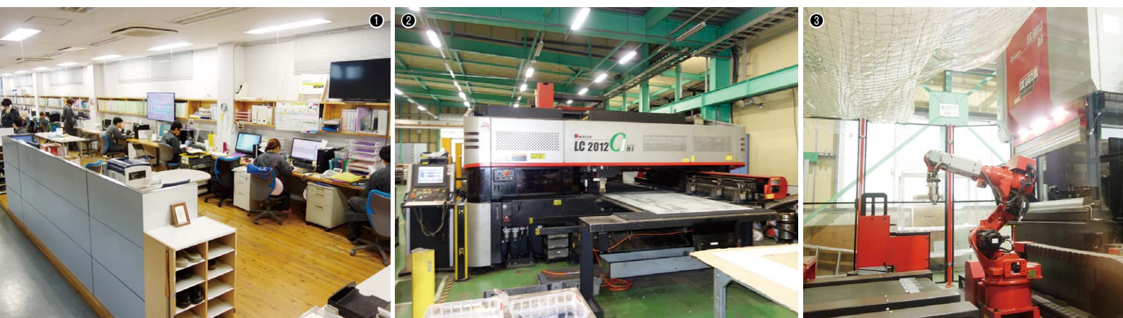
① 同社の設計室 / ② 同社の主要設備であるパンチ・レーザ複合マシンLC-2012C1NT。稼働状態を遠隔地でも確認できるようにネットワークカメラで常時モニタリングしている / ③ ペンディングロボットEG-6013AR+EGROBOT
