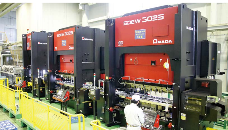
サーボプレスSDEW-3025×2台とSDE-3030をトランスファー装置で連結したタンデムライン
