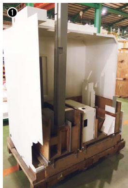
① 完成したカバーは機種別に用意された搬送治具に仮組みされた状態で設置され、本社工場の組立ラインに搬送される / ② 木製の搬送治具 / ③ 作業の進捗は工場内の管理ボードで確認できる
