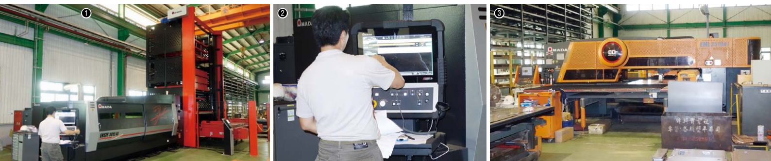
①ファイバーレーザーマシンENSIS-3015 AJ+ASFH-3015 G / ②ENSIS-3015 AJのAMNC 3iの画面でネスティングデータを確認する / ③フロントカバーが指定色に塗られたパンチ・レーザー複合マシンEML-3510 NT
