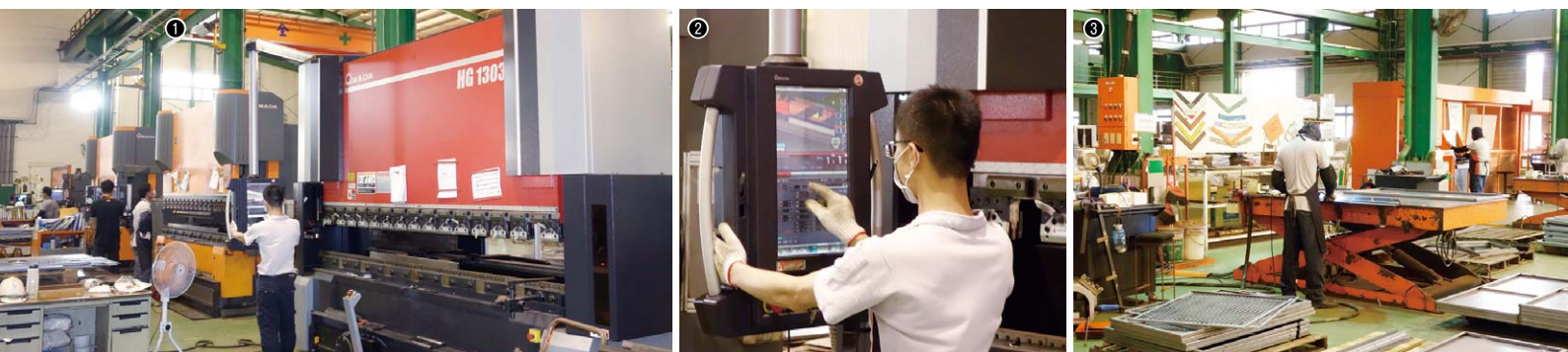
①ベンディングマシンHG-1303(手前) / ②HG-1303のコンソールAMNC 3iの画面で外段取りで作成された加工データを呼び出す / ③溶接工程
