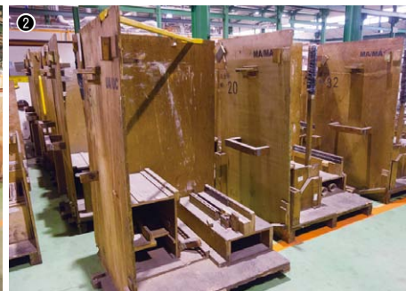
① 完成したカバーは機種別に用意された搬送治具に仮組みされた状態で設置され、本社工場の組立ラインに搬送される / ② 木製の搬送治具 / ③ 作業の進捗は工場内の管理ボードで確認できる
