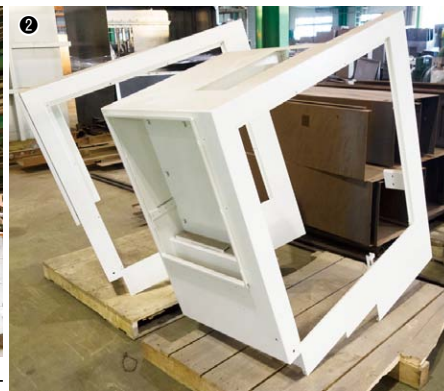
① 塗装ラインは粉体塗装 / ② 塗装が終了したカバー
