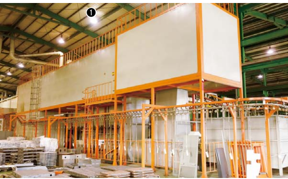
① 塗装ラインは粉体塗装 / ② 塗装が終了したカバー
