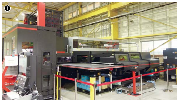
①ファイバーレーザー複合マシンACIES-2515 T-AJ+ASR-3015 NTK / ②ACIES-AJによる高品質加工 / ③ACIES-AJで加工した長尺製品。VPSS 3iを活用することで長尺製品も一発で加工できるようになった
