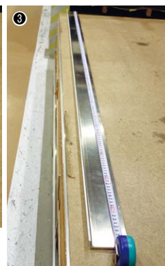
①ファイバーレーザー複合マシンACIES-2515 T-AJ+ASR-3015 NTK / ②ACIES-AJによる高品質加工 / ③ACIES-AJで加工した長尺製品。VPSS 3iを活用することで長尺製品も一発で加工できるようになった
