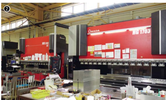
①VPSS 3i BENDで曲げ加工データを全自動で作成する / ②HG-1703などが並ぶ曲げ工程 / ③曲げ加工された製品
