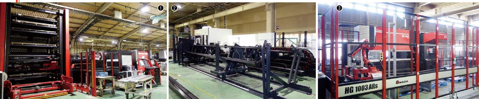
①パンチ・レーザ複合マシンEML-3510NT+ASR-2512NTK / ②パイプ加工専用レーザマシン / ③2017年11月に導入したベンディングロボットシステムHG-1003ARs+HGROBOT-20
