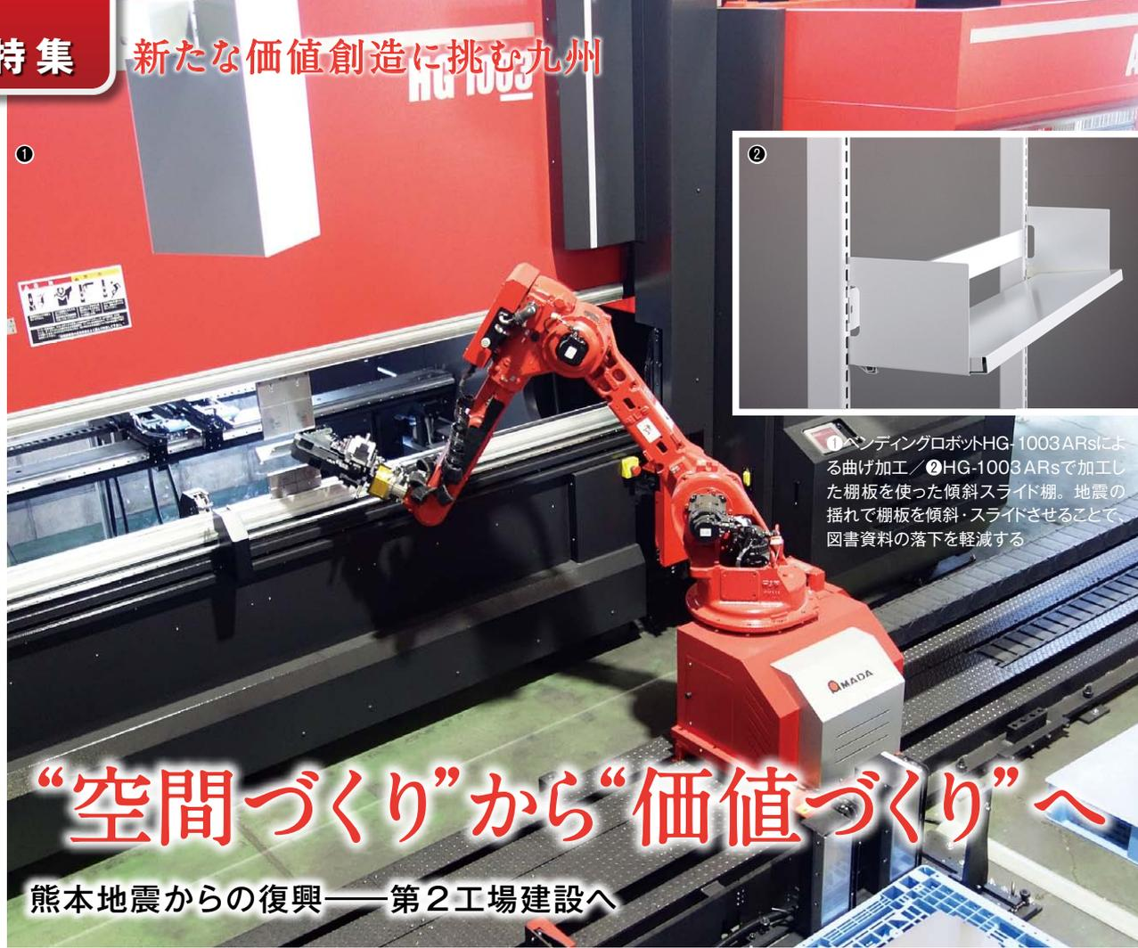
①ベンディングロボットHG-1003 ARsによる曲げ加工／②HG-1003 ARsで加工した棚板を使った傾斜スライド棚。地震の揺れて棚板を傾斜・スライドさせることで、図書資料の落下を軽減する
