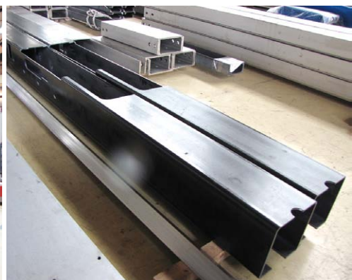
パイプレーザーカッティングマシンで加工した角パイプ
