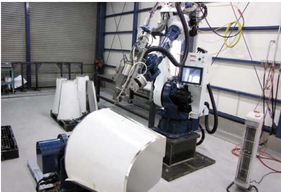
レーザー溶接機によるアルミ製品の溶接
