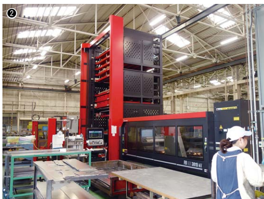
①2017年8月に導入したACIES-2515T-AJ+AS-3015NTK+ULS-3015NTK / ②レーザマシンFO-MII 3015NT+ASF-3015G / ③FO-MIIでは識別のために製番などのレーザマーキングを行う
