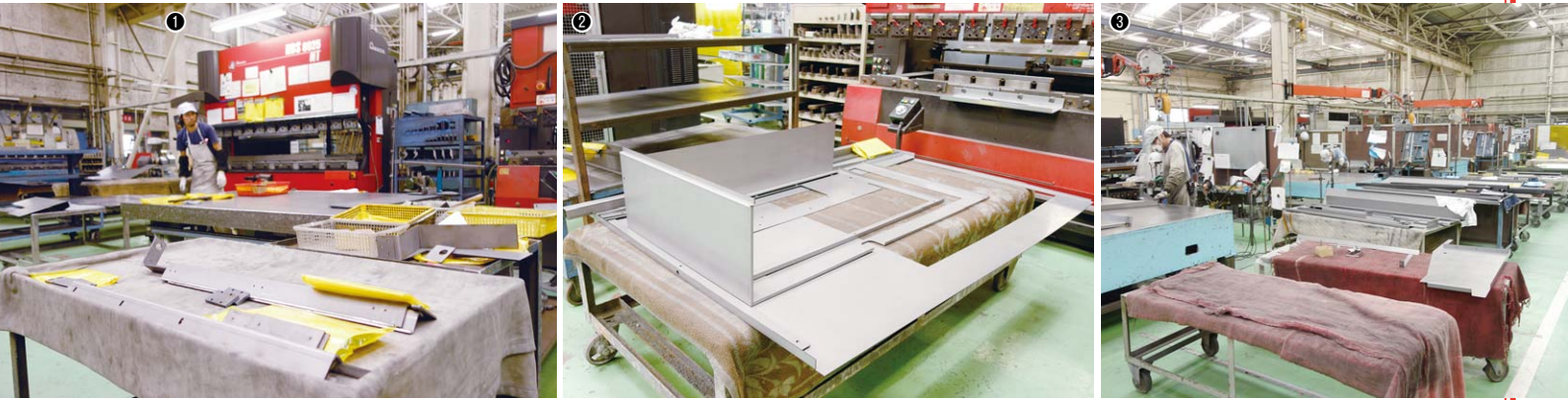
①HDS-8025NT(奥)などによる曲げ加工品(手前)／②曲げ加工が終わった製品は“号機単位”で台車にまとめられる／③溶接テーブルは11台。“号機単位”にまとめられた製品が溶接工程に集まってくる
