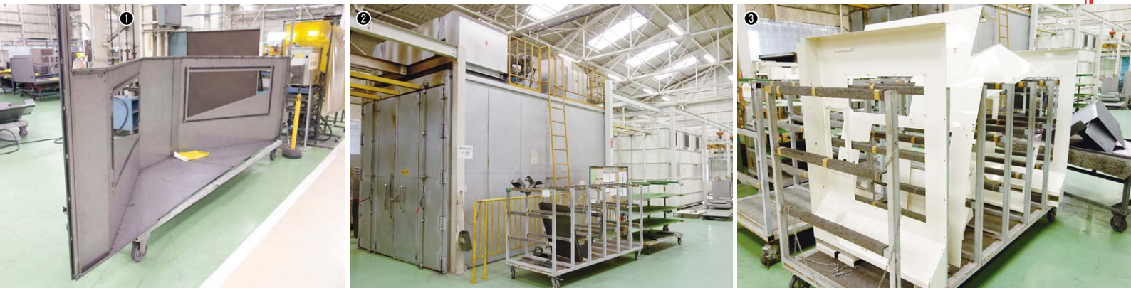
①溶接が完了した工作機械カバーのサブアッシー／②ジェイテクト・刈谷工場から移設された粉体塗装設備／③塗装が終了した工作機械カバーが組み付けを待つ
