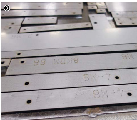
①2017年8月に導入したACIES-2515T-AJ+AS-3015NTK+ULS-3015NTK / ②レーザマシンFO-MII 3015NT+ASF-3015G / ③FO-MIIでは識別のために製番などのレーザマーキングを行う
