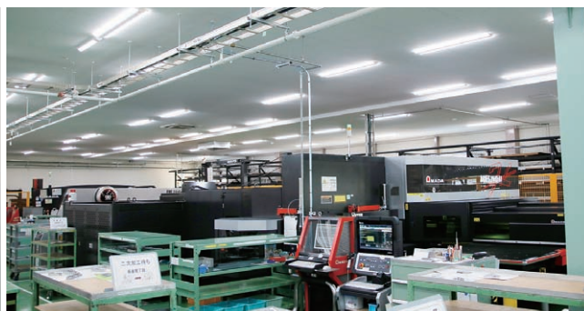
ブランク工程。ファイバーレーザー複合マシンACIES-2512B-AJ+RMP-2512TK(手前)と、パンチレーザー複合マシンEML-3510NTP+MJC(奥)。両機とも自動倉庫MARSと連動している
