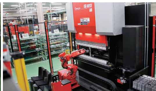
ベンディングロボットシステムEG-6013 ARによる曲げ加工
