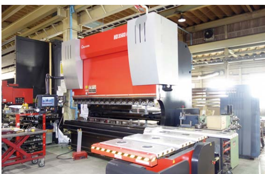
厚板の曲げ加工に対応するHD-3503NT
