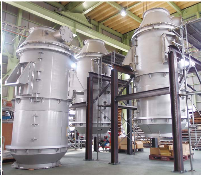
左: ガスタービン吸入空気を清浄化するフィルターハウス 右: 艦船向けのガスタービン主発電機排気管。漏洩検査が完了し出荷される
