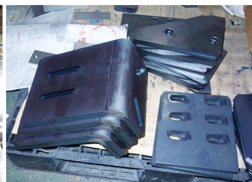
HD-3503NTで曲げ加工した板厚16mmの製品
