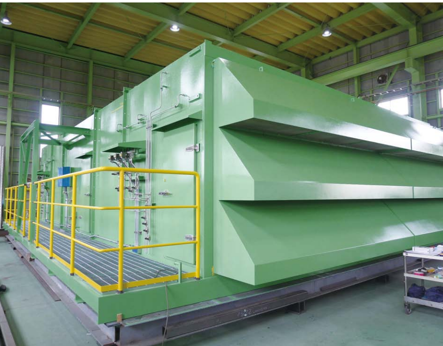
左: ガスタービン吸入空気を清浄化するフィルターハウス 右: 艦船向けのガスタービン主発電機排気管。漏洩検査が完了し出荷される
