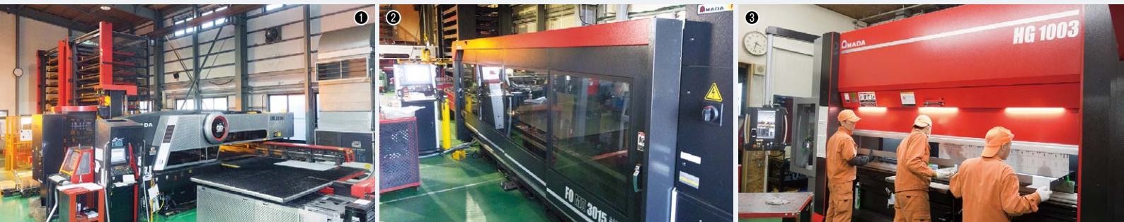
①パンチ・レーザ複合マシンEML-3510NT(2連棚・PDC仕様) / ②レーザマシンFO-MII 3015NT / ③ベンディングマシン HG-1003
