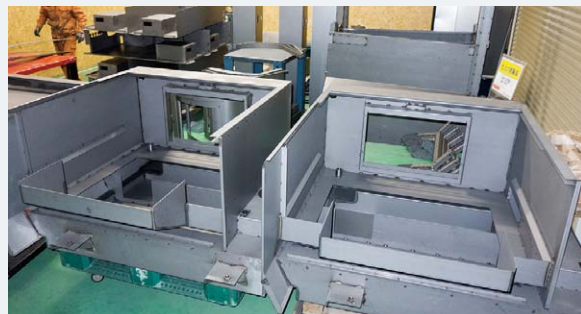
溶接・組立後の工作機械カバー
