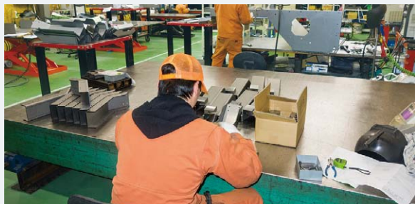
アSEMBリー生産によりブランク・曲げ・溶接の工程最適化に取り組んでいる溶接・組立工程
