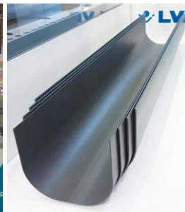
左：LVDはSynchrono-Formという適応制御可能なベンディングマシンを出展し、幾何学形状の曲げ加工を実現。自動測定により、あらゆる曲がり角を補正する 右：Synchrono-Formで加工された製品
