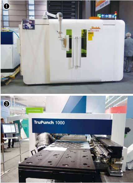
①トルコの Baykalが展出了したファイバーレーザーマシン／②中国の大族激光 (Han's Laser) が展出了したファイバーレーザーマシン／③Trumpfがエントリーモデルとして発表したモジュール構成のパンチングマシン。同マシンにレーザー加工モジュールを組み合わせてとコンビネーションマシンになる
