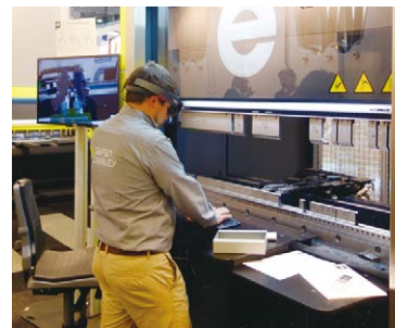
Safan DarleyはMicrosoftの「HoloLens」を使いながら曲げ作業をする様子を実演
