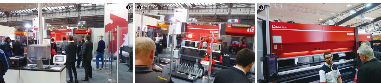
①ベンディングロボットシステムHG-1003 ARsや自動金型交換装置(ATC)付きのベンディングマシンHG-2204 ATCを出展。曲げ加工ソリューションに対する来場者の評価は高い／②HG-1003 ARs。多品目一括金型段取りソフトと組み合わせることで、多品種少量生産に対応したステップバンドの金型レイアウトも可能になる／③多品目一括金型段取りによる、金型段取りの自動化・自動角度出しが可能なHG-2204 ATC
