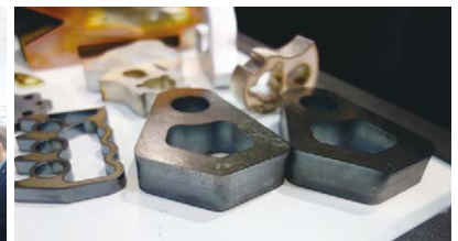
左: ヤマザキマザックが出展したDDL搭載のレーザマシン。TeraDiode製のDDL発振器 (4kW) を搭載。欧米で販売を開始した 右: DDLで加工した厚板のワーク (軟鋼・ステンレスなど)。切断面品質はCO 2 レーザと比較しても遜色がない
