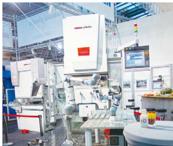
フィンランドのUrsvikenが出展したロボットシステム。2台のロボットによる共同作業で曲げ加工を行う
