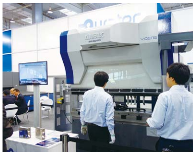
イタリアのSchiavi（左）や村田機械（右）は、ベンディングマシンの上部テーブルに操作画面を映し出し、操作性を改善するシステムを提案した
