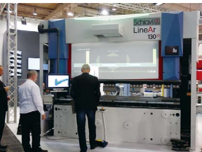
イタリアのSchiavi（左）や村田機械（右）は、ベンディングマシンの上部テーブルに操作画面を映し出し、操作性を改善するシステムを提案した
