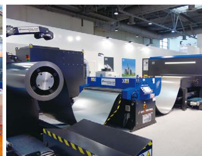
DANOBATはコイル材から切断できるファイバーレーザーマシンを出展
