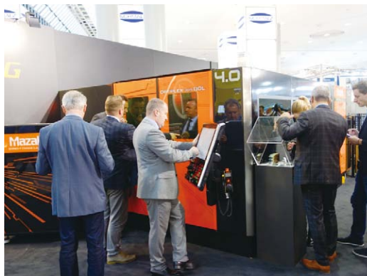
左: ヤマザキマザックが出展したDDL搭載のレーザマシン。TeraDiode製のDDL発振器 (4kW) を搭載。欧米で販売を開始した 右: DDLで加工した厚板のワーク (軟鋼・ステンレスなど)。切断面品質はCO 2 レーザと比較しても遜色がない
