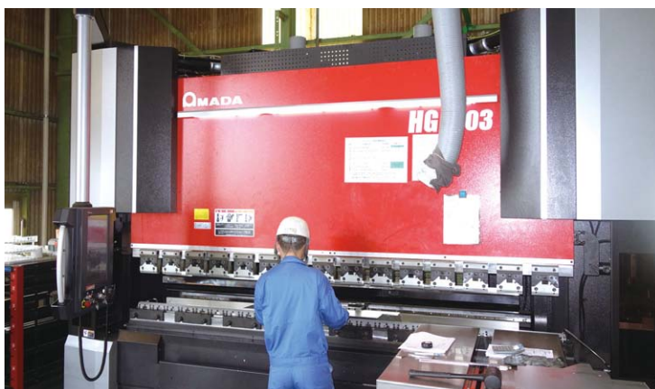
左：ベンディングマシンHG-1703 右：ブランク材はキット単位で台車に管理されている
