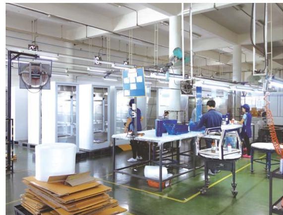
通信機器筐体の電装組込ライン
