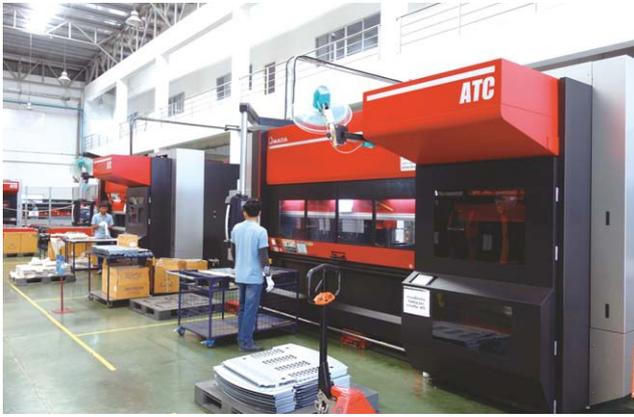
自動金型交換装置付きベンディングマシンHG-1003ATC
