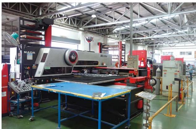
パンチ・レーザー複合マシンEML-3510NT+ASR-48M
