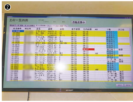
①10台以上のベンディングマシンを設備／②受注した試作品の製番ごとに工程進捗や実績を確認できるなど“見える化”にも注力 ③試作品は3次元測定機で測定し、設計データとの比較検査を行う
