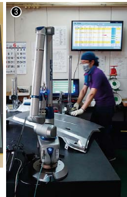
①10台以上のベンディングマシンを設備／②受注した試作品の製番ごとに工程進捗や実績を確認できるなど“見える化”にも注力 ③試作品は3次元測定機で測定し、設計データとの比較検査を行う
