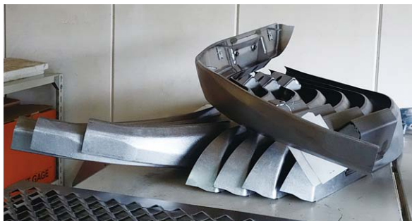
叩き成形加工で作成した農業用トラクターのフェンダー
