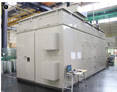
①同社で製作した水素製造装置向け防音ボックス／②防音ボックスの組立まで終えたあとは、騒音測定器などを用いた防音検査を実施
