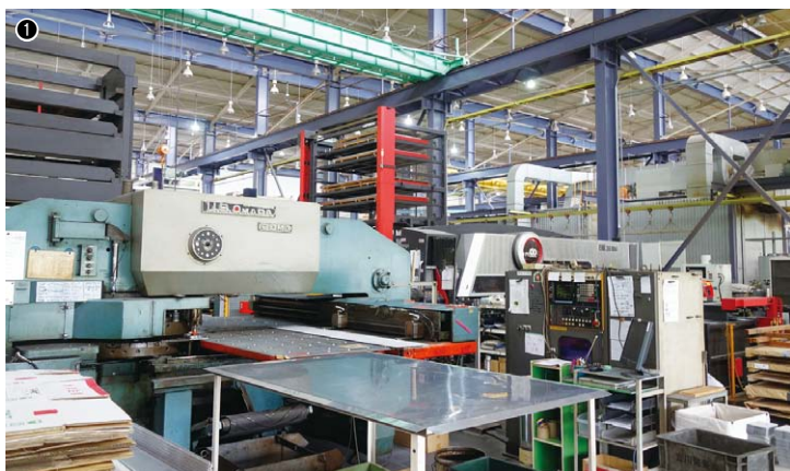
①パンチ・レーザ複合マシンEML-3610NT+ASR-510M(奥)と、長年同社に貢献しているパンチングマシンCOMA-557(手前) ②工程の“見える化”にも取り組む
