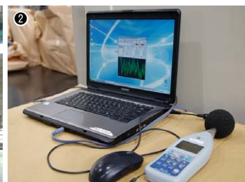
①同社で製作した水素製造装置向け防音ボックス／②防音ボックスの組立まで終えたあとは、騒音測定器などを用いた防音検査を実施
