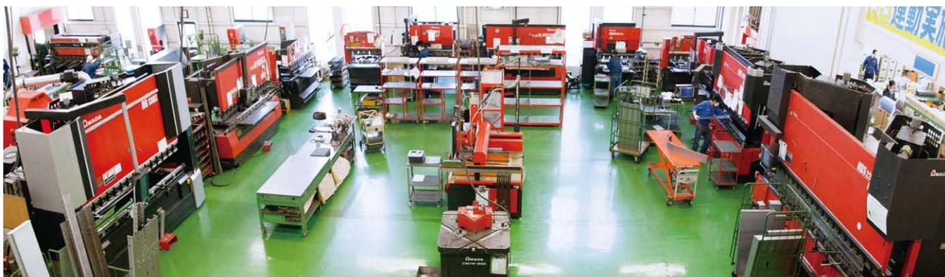
曲げ工程には、HG-1303 (3m対応) や4m対応のHDS-2204NTがある一方、サーボベンダー FMB-3613NT×3台も設備。大型製品から精密小物製品まで幅広く対応する
