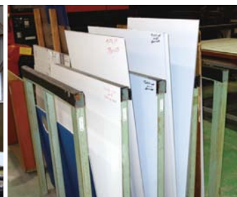
端材が出る材質・大きさを マーキングして端材登録を行う
