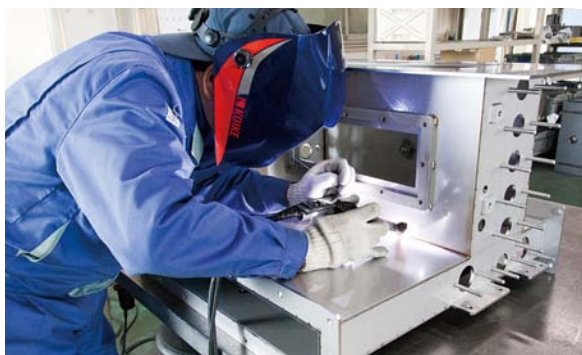
液晶製造プロセスの印刷工程で使う搬送台車の溶接作業
