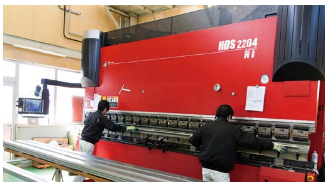
ベンディングマシンHDS-2204 NTによる太陽光発電パネル架台の曲げ加工
