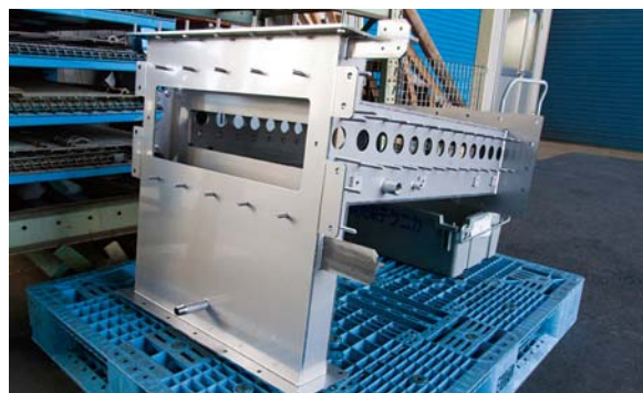
液晶製造装置のノズル搬送台車部品
