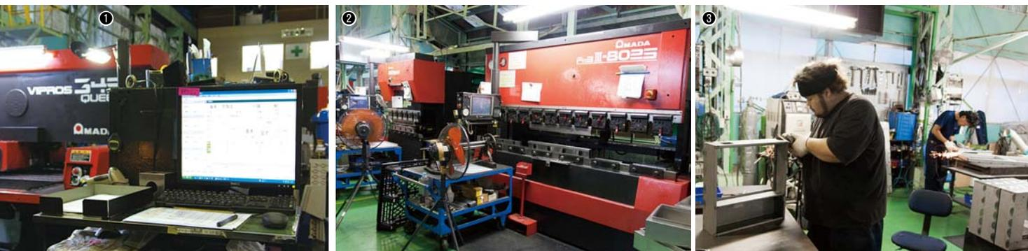
①現場の3カ所に設置されたデスクトップPCから「板金まるごと管理システム」の受注台帳閲覧や進捗実績登録ができる／②ネットワーク対応型ベンディングマシンが2台並ぶ／③溶接組立工程
