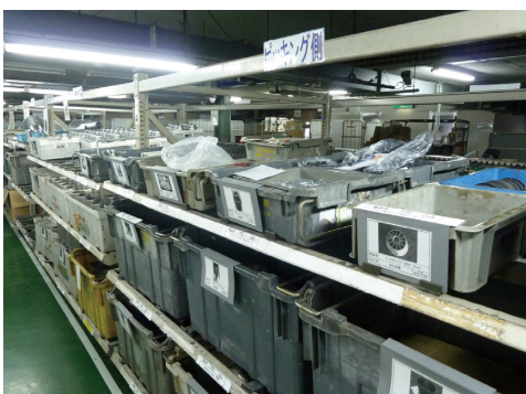
各種部品を管理する部品棚には製品の姿図が貼られており、ピッキングのミス・ロスを防止
