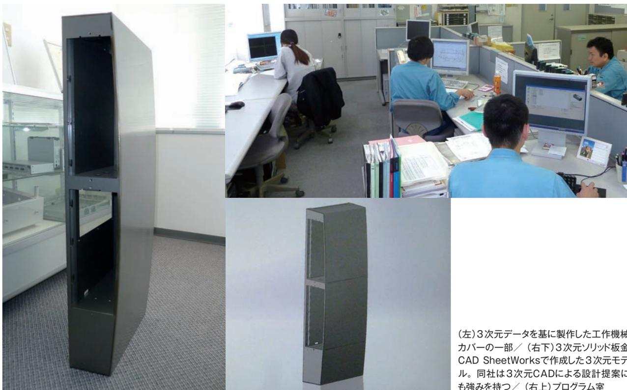
(左)3次元データを基に製作した工作機械カバーの一部／(右下)3次元ソリッド板金CAD SheetWorksで作成した3次元モデル。同社は3次元CADによる設計提案にも強みを持つ／(右上)プログラム室
