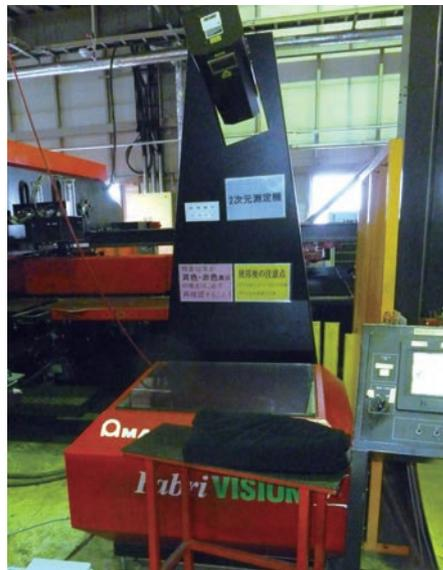
ブランク加工前には、非接触2次元検査装置FabriVISION Laserでブランク検査を行う
