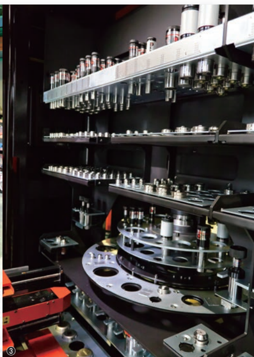
① 今年4月、第2工場に導入したパンチング全自動型ソリューションマシンEM-3612ZRT+AS-3015NTK+ULS-3015NTK。第2工場にはWebカメラ(丸カコミ)を4台設置し、本社の事務所にいながらいつでも状況を確認できる／② EM-ZRのシステムアップ。左から材料棚(AS-3015NTK)、製品棚(ULS-3015NTK)、ID金型300本の自動交換が可能なラックモジュールとなっている／③ ラックモジュール内のID金型
