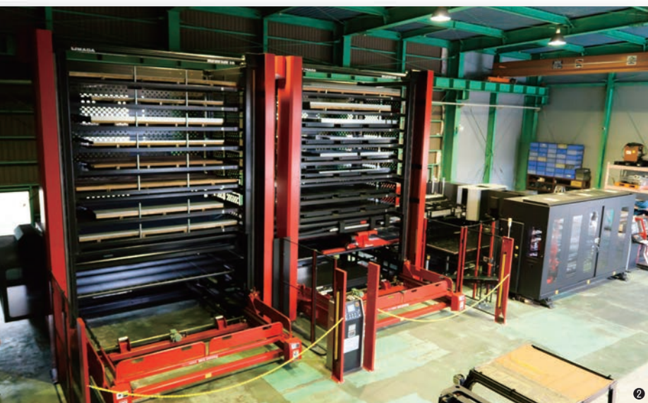
① 今年4月、第2工場に導入したパンチング全自動型ソリューションマシンEM-3612ZRT+AS-3015NTK+ULS-3015NTK。第2工場にはWebカメラ(丸カコミ)を4台設置し、本社の事務所にいながらいつでも状況を確認できる／② EM-ZRのシステムアップ。左から材料棚(AS-3015NTK)、製品棚(ULS-3015NTK)、ID金型300本の自動交換が可能なラックモジュールとなっている／③ ラックモジュール内のID金型
