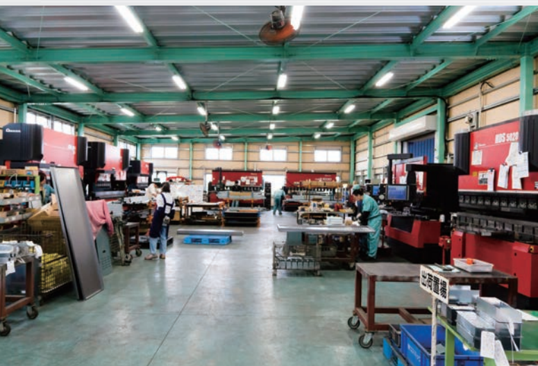
曲げ工程には9台のベンディングマシンを配置。このうち6台は建材関連、3台は昇降機メーカーとその他の得意先向けの製品を加工している
