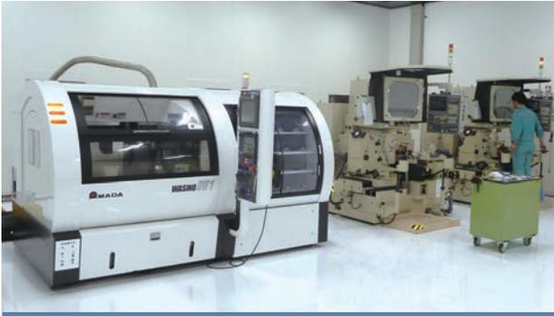
地下工場内の加工エリア“Cラボ”に導入されているプロファイル研削盤
