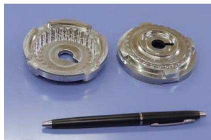
厚板サイクロイド歯車。CFP工法による順送プレス加工で、機械加工と同等の加工精度を実現
