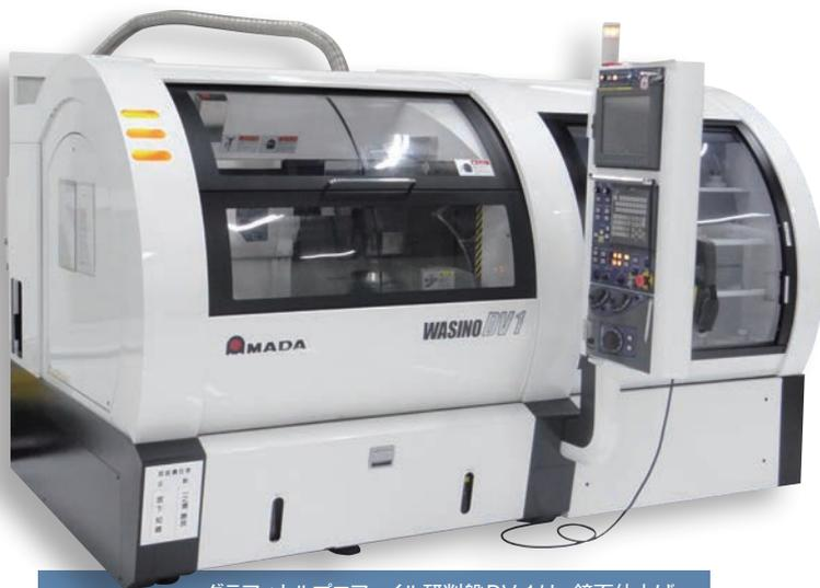
グラフィカルプロファイル研削盤DV-1は、鏡面仕上げまでの一貫加工やCCDカメラによる机上計測などに対応
