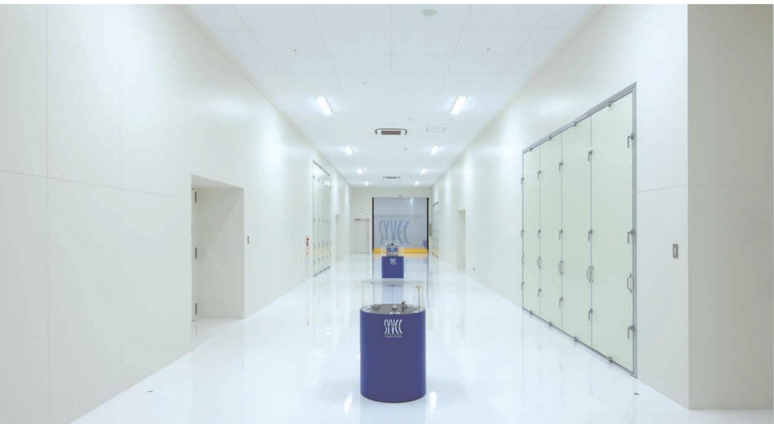
地下11mに建設された金型製作用の地下工場(2,500m)。地下工場内の温湿度を徹底的に管理することで、究極の金型製作環境を実現している
