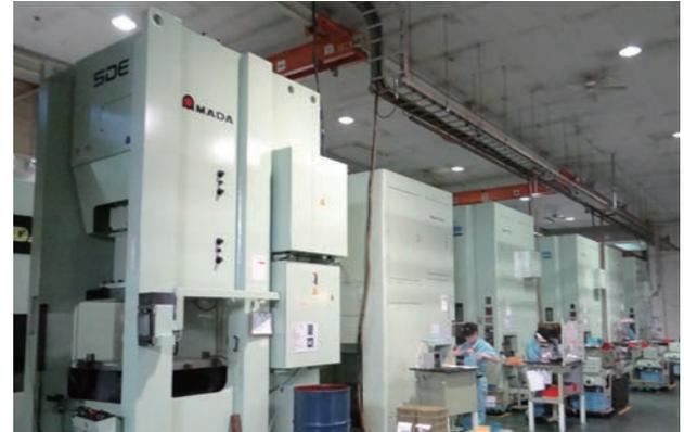
本社工場にある試作ライン。先頭工程のデジタル電動サーボプレスSDE-3030はブランク加工用として活用している
