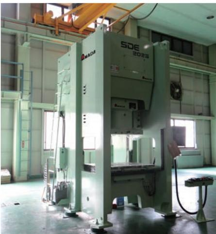
SDE-2025を先頭工程とした自動化プレスラインは、9月稼働を目前に敷設中
