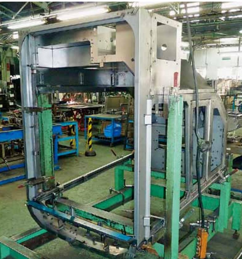
コンバインのキャビンの溶接工程 (部品点数 40 ~ 50 点)
