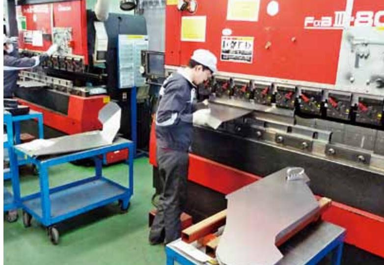
R 曲げ・角度曲げのある複雑形状の製品をステップバンド加工で対応
