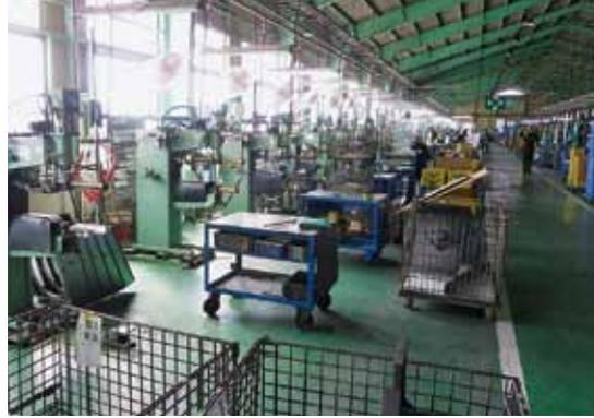
東工場にはスポット溶接機×38台が設備されている
