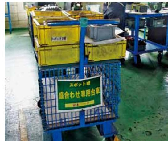
溶接作業者が作業指示書にしたがって棚から必要な子部品をピックアップ。「盛合わせ専用台車」で運びスポット溶接を行う
