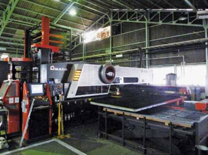
パンチ・レーザ複合マシン EML-3510NTP セル (供給棚・金型自動交換装置付き)。
