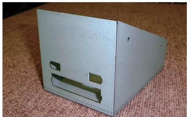
仕上げ工程のYAGレーザーで溶接された筐体
