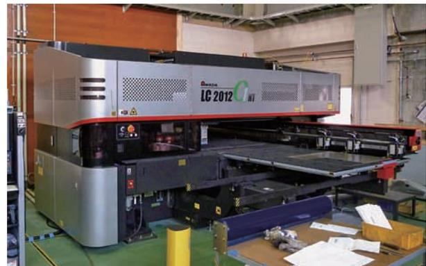
昨年12月の移転時に導入された工程統合マシン LC-2012C1NT。稼働率を上げるために期待を込めて導入された
