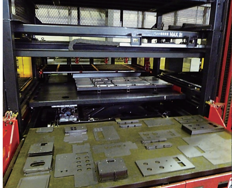
EML+TK でネスティングされたパーツが集積され、アンローディングステーションにあるパレットに自動で整列・積載される
