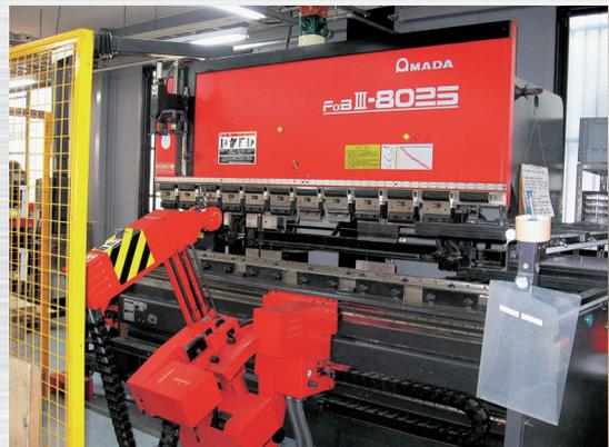
ベンディングマシン FDB III-8025NT にベンディングロボットシステム ASTRO-100M であるが付加され、多品種にもフレキシブルに対応、生産性を上げている
