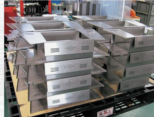
食品関係の情報端末装置の操作パネル。C1 で製造するようになり 2 倍以上の生産性をあげている
