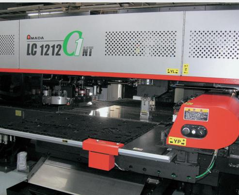
今年の春に導入された工程統合マシン LC-1212C1NT。OVS を活用して掴み替えなどにも加工原点が狂わないようになり、加工精度がグンと向上した
