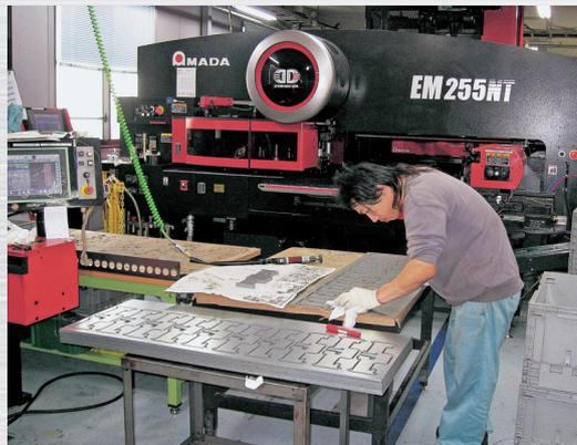
パンチングマシン EM-255NT は2台が稼働。スケッチ材でマイクロジョイントされた製品が、ヒトの目によって確認される
