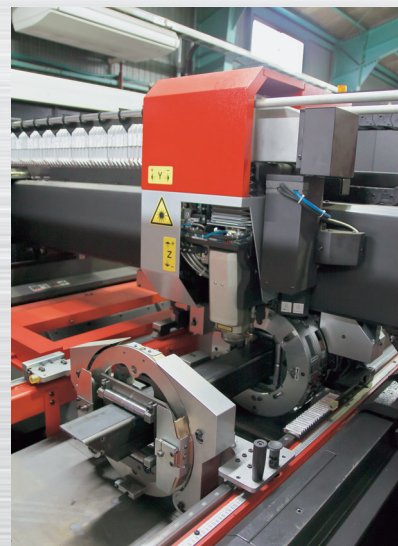
ロータリーインデックスを装備した FO-M II による角パイプ加工
