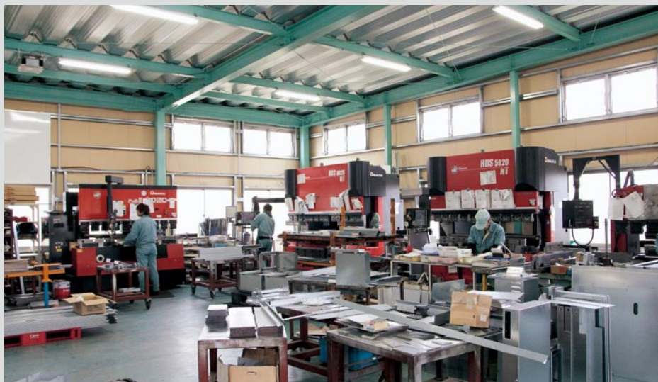
3台のネットワーク対応型ベンディングマシンが並ぶ曲げ工程
