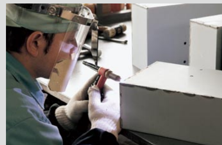
アルゴン溶接による溶接・組立工程
