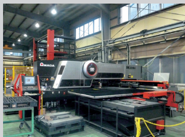
2009年に導入したパンチ・レーザ複合マシンEML-3510NT+ASR-48M+TKが効率よく仕事を消化していく
