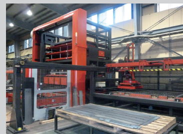
レーザマシンLC-3510F1NTの板厚では12mmまでのTK(テイクアウト)装置は同社が第一号
