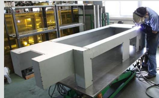
印刷機カバールの溶接・組立工程。
