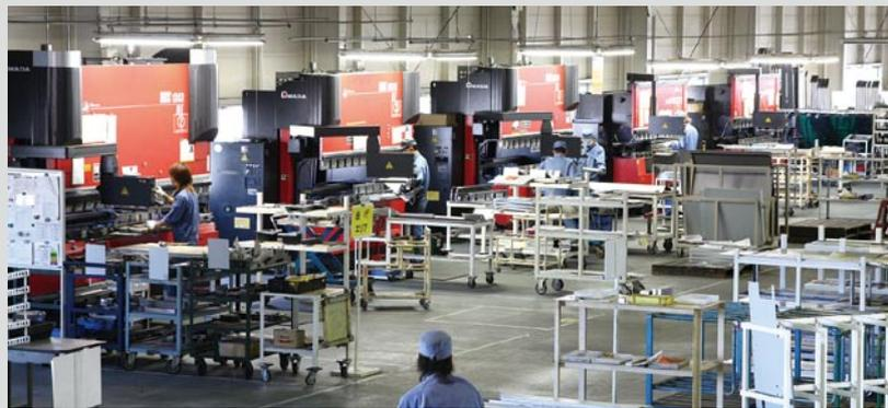
ネットワーク対応型ベンディングマシンがズラリと並ぶ曲げ工程。
