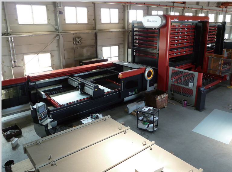
今年3月に導入したLC-4020F1NT+AS-4020F1は4kWの発振器を搭載している。
