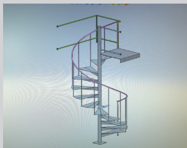
SheetWorksで作成した螺旋階段の製品モデル。
