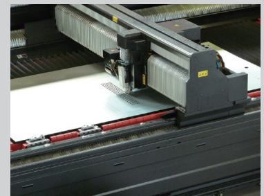
5' \times 10' のボンデ鋼板(12mm)に高速で穴あけ加工する。
