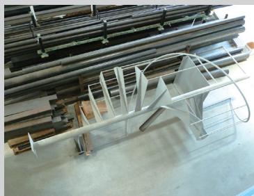
溶接組立が終わり集荷を待つ螺旋階段。
