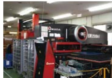
EM-2510NT+ASR-48Mによる抜き加工。
