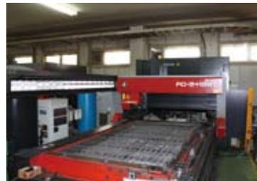
レーザーマシンFO-2412NTによる試作部品の加工。
