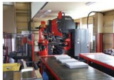
ASTRO-100NT+ASTRO MP-20には5m、2連の製品積載コンベヤーが装備されており、曲げ加工が終了した製品はここに整列積載される。5mで6時間稼働に対応できる。
