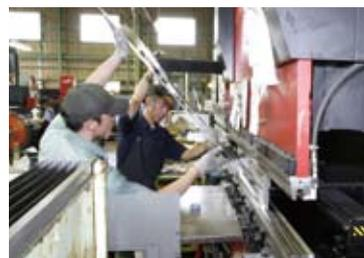
HDS-8025NTによる長尺製品の曲げ加工は2人がかりで行う場合が多い。
