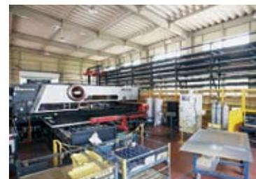
パンチ・レーザ複合マシンEML-3510NT +RMP-48M+MARSの稼働は目標時間に近い。
