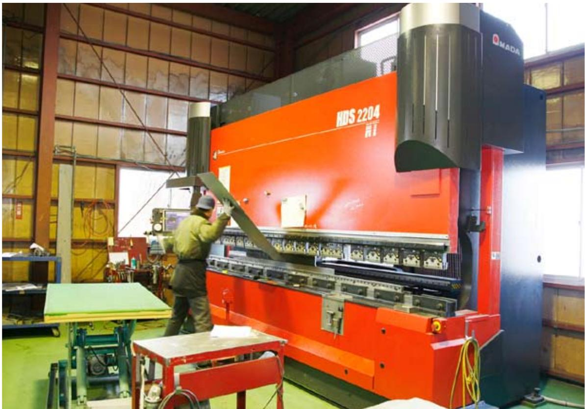
HDS-2204NTによる曲げ作業。大型板金に対応した4m、220t プレスブレーキ。
