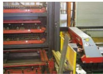
2001年に導入した3kW発振器を搭載したレーザーマシンFO-3015+ASF-3015FO。
