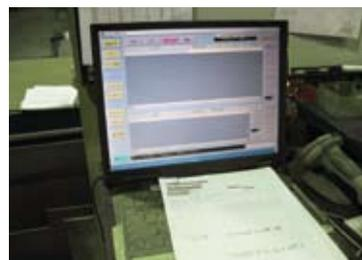
WILL受注出荷モジュール+Mの端末から着手、完了情報をバーコード入力して進捗管理を行う。
