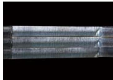
FO-3015で加工したSS材12mmの切断面。
