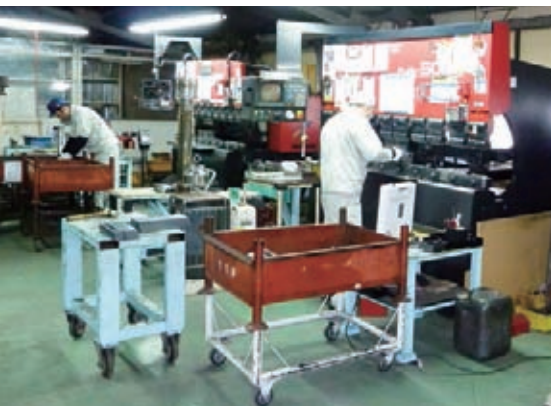
曲げ工程。溶接の自動化には曲げ加工精度の向上が欠かせないため、ベンディングマシンHG-1303の導入を決断した(写真は導入前)
