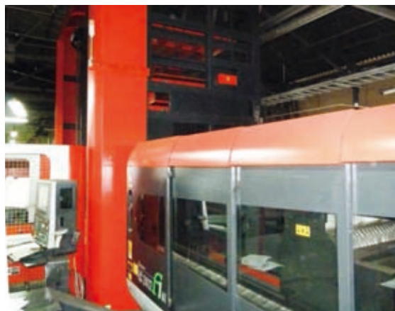
棚付きのレーザマシンLC-2412F1NT。レーザ加工で溶接の簡易治具なども製作できるようになった
