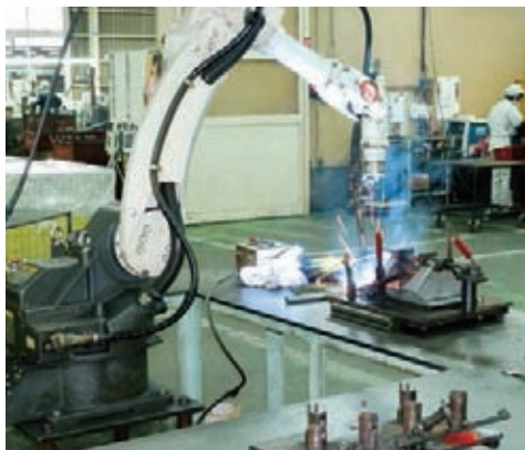
溶接ロボットの増強で溶接の自動化を推進している
