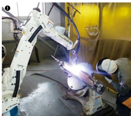
① 6軸制御のTIG溶接ロボットでCFRP製造工程の炭素繊維噴き出しノズルの溶接を行う／②炭素繊維噴き出しノズルの出荷検査
