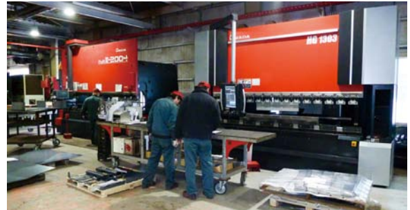
2014年に導入したファイバーレーザーマシンFLC-3015AJ+LST-3015F1(上)とベンディングマシンHG-1303(下・手前)
