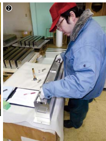
① 6軸制御のTIG溶接ロボットでCFRP製造工程の炭素繊維噴き出しノズルの溶接を行う／②炭素繊維噴き出しノズルの出荷検査
