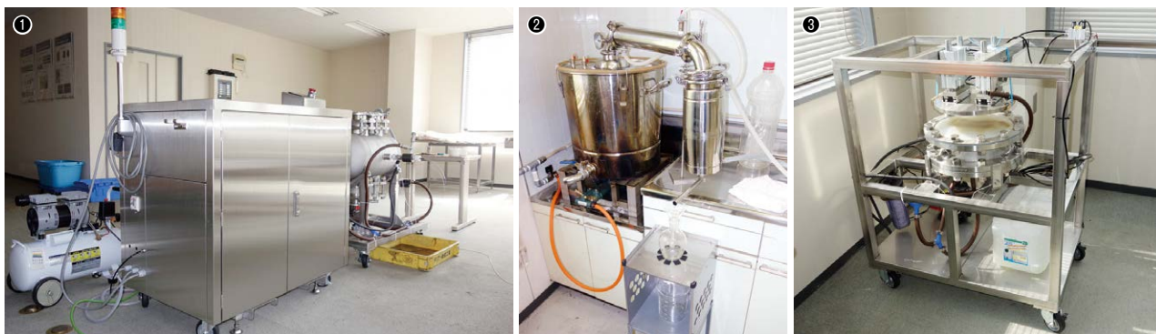
①クロモジ用衝撃波破碎装置。1回あたり150gのクロモジの葉や小枝を5秒間で処理できる／②衝撃波破碎処理をしたクロモジの葉や小枝を蒸留窯に充填して水とともに加熱。発生した蒸気を冷却して、精油にする／③漆用の衝撃波破碎装置
