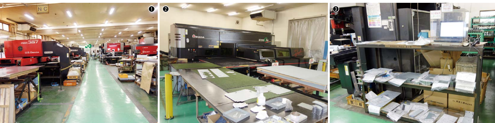
①板金事業を行う工場内部／②スタンドアローンのマシンとしては非常に高い稼働率を誇るLC-2512C1AJ／③現場端末と仕掛り製品棚
