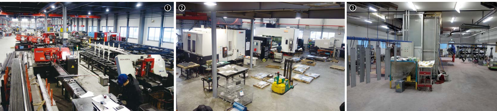
①形鋼を加工する形鋼加工工場／②機械加工工場。5面加工機や各種マシニングセンタ、NC旋盤などが並ぶ／③塗装ライン
