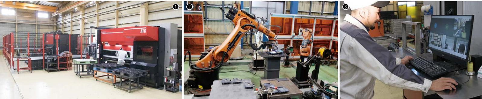
①曲げ工程ではベンディングロボットシステムHG-2204 ARm(奥)と自動金型交換装置付きベンディングマシンHG-1003 ATC(手前)を作業員1名が担当／②ロボット3台(ワーク把持+溶接部材供給+溶接)による治具レス溶接ロボット／③各工程にはPC端末が設置され、定時ミーティングはWeb会議システムを使用する
