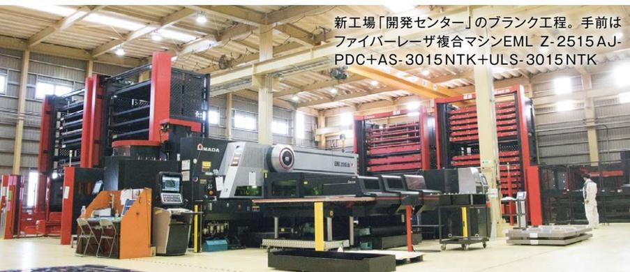
新工場「開発センター」のブランク工程。手前はファイバーレーザ複合マシンEML Z-2515AJ-PDC+AS-3015NTK+ULS-3015NTK
