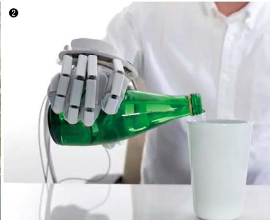
① 双腕ロボットがビジョン(カメラ)で製品を識別してピッキングするシステムを自社開発し、活用している/② 手指の機能回復を目指すアシストロボット装具「SMOVE」
