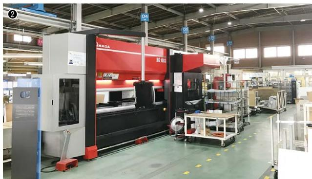
①今年3月に導入したファイバーレーザーマシンVENTIS-3015 AJ+ASFH-3015 G+TK-3015 L / ②自動金型交換装置付きベンディングマシンHG-1003 ATC。所在管理システム「Location Data Analyzer」で台車の所在地を示す番地が、工場内の柱の上部に表示されている
