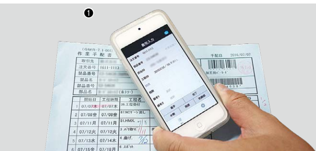
①iPod touchのカメラで作業指示書のバーコードを読み込み、着手・完了情報を登録する／②2018年に開設した物流倉庫「マキノパーツセンター」(MPC)／③「マキノパーツセンター」(MPC)は自動搬送機能を備え、パレットは約1万個、バレットは約230個収納できる。出荷作業を平準化し、工場全体の生産性が向上した
