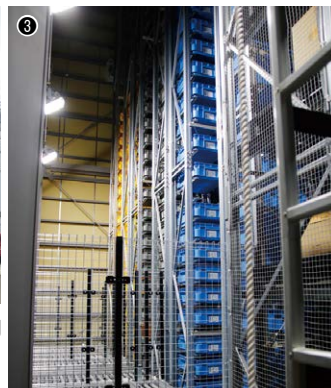
①iPod touchのカメラで作業指示書のバーコードを読み込み、着手・完了情報を登録する／②2018年に開設した物流倉庫「マキノパーツセンター」(MPC)／③「マキノパーツセンター」(MPC)は自動搬送機能を備え、パレットは約1万個、バレットは約230個収納できる。出荷作業を平準化し、工場全体の生産性が向上した
