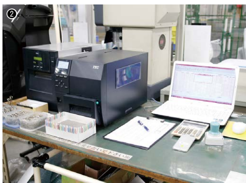
①ファイバーレーザ溶接システムFLW-4000。ステンレスなどの高品位な溶接に対応する／②梱包工程ではラベル印刷機が現品票を自動出力する／③梱包を終え、現品票を貼付した製品
