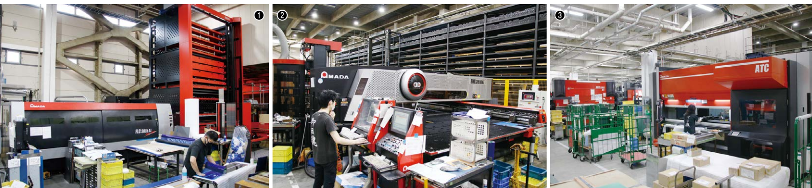
①ファイバーレーザーマシンFLC-3015AJ+ASFH-3015 / ②パンチ・レーザー複合マシンEML-3510NTP。奥の材料自動倉庫HYPER MARSと連動し、24時間フル稼働する / ③曲げ工程。自動金型交換装置付きベンディングマシンHG-1003ATC (手前)などが並ぶ
