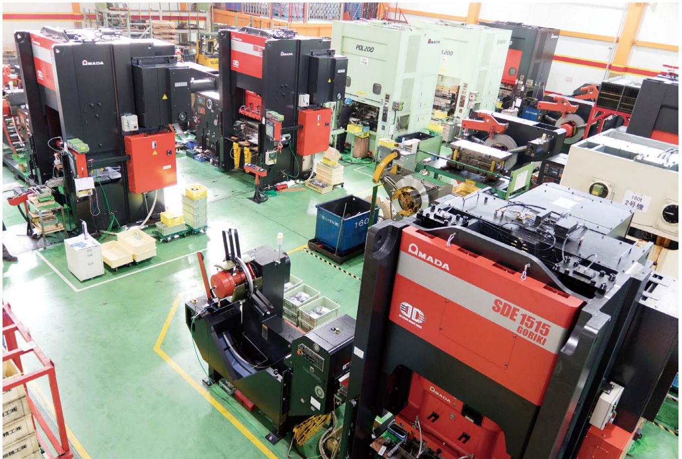
自動車用電装部品や電子機器向け精密部品を生産する輪之内第2工場。高剛性サーボプレスSDE-GORIKIが3台のほか、高剛性・高精度ナックルリンクプレスPDLが6台(300トン×1台、200トン×5台)設備されている
