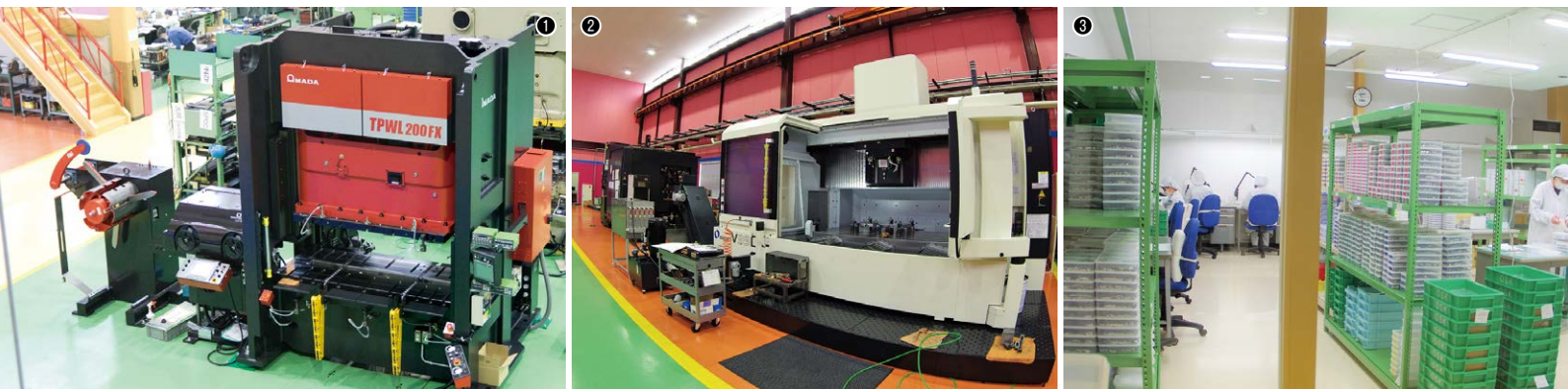
①大垣西工場に導入されたダブルリンクプレスTPWL-200FX+オリメック製レベラーフィーダー LCC03KR3 / ②大型の立形マシニングセンタをはじめとした金型加工設備(大垣西工場) / ③超精密部品の外観検査・梱包を行うクリーンルーム(大垣西工場)
